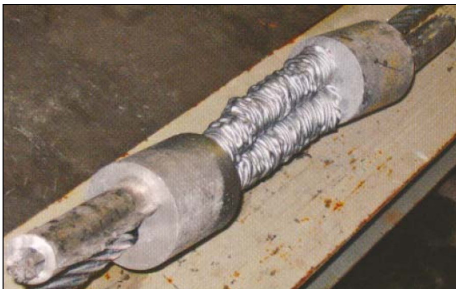
Figura 10-8 – Dispositivo de disipación de energía por deformación plástica
