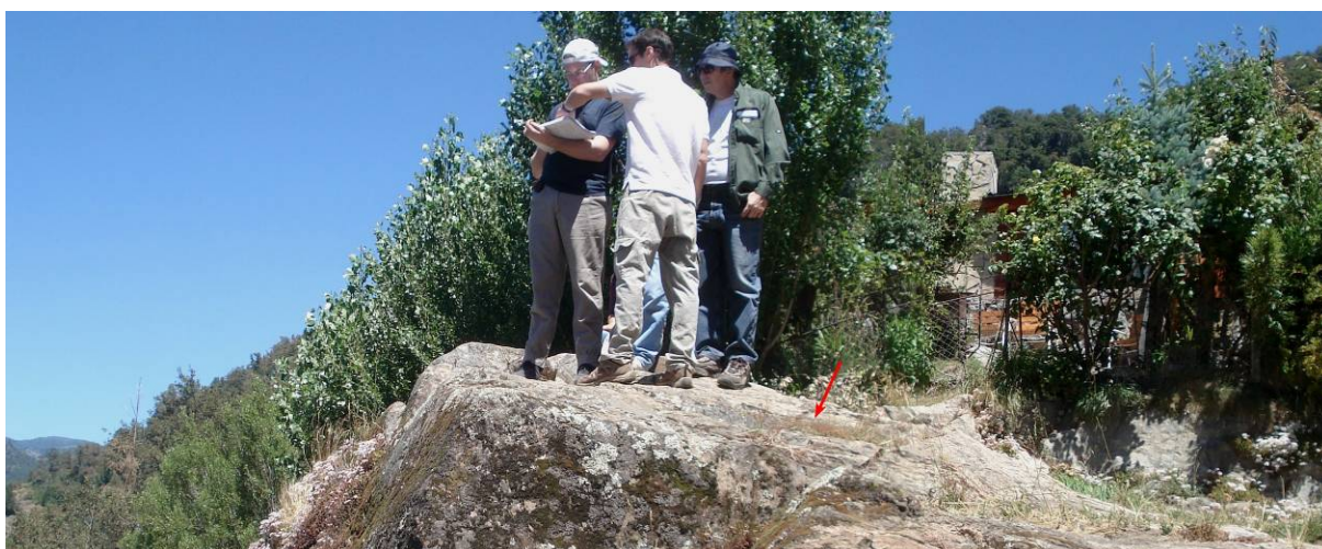
Figura 7-10 – La flecha indica la superficie de un plano de fracturación de baja inclinación presente en las rocas metamórficas del Complejo Coiohuincul.
