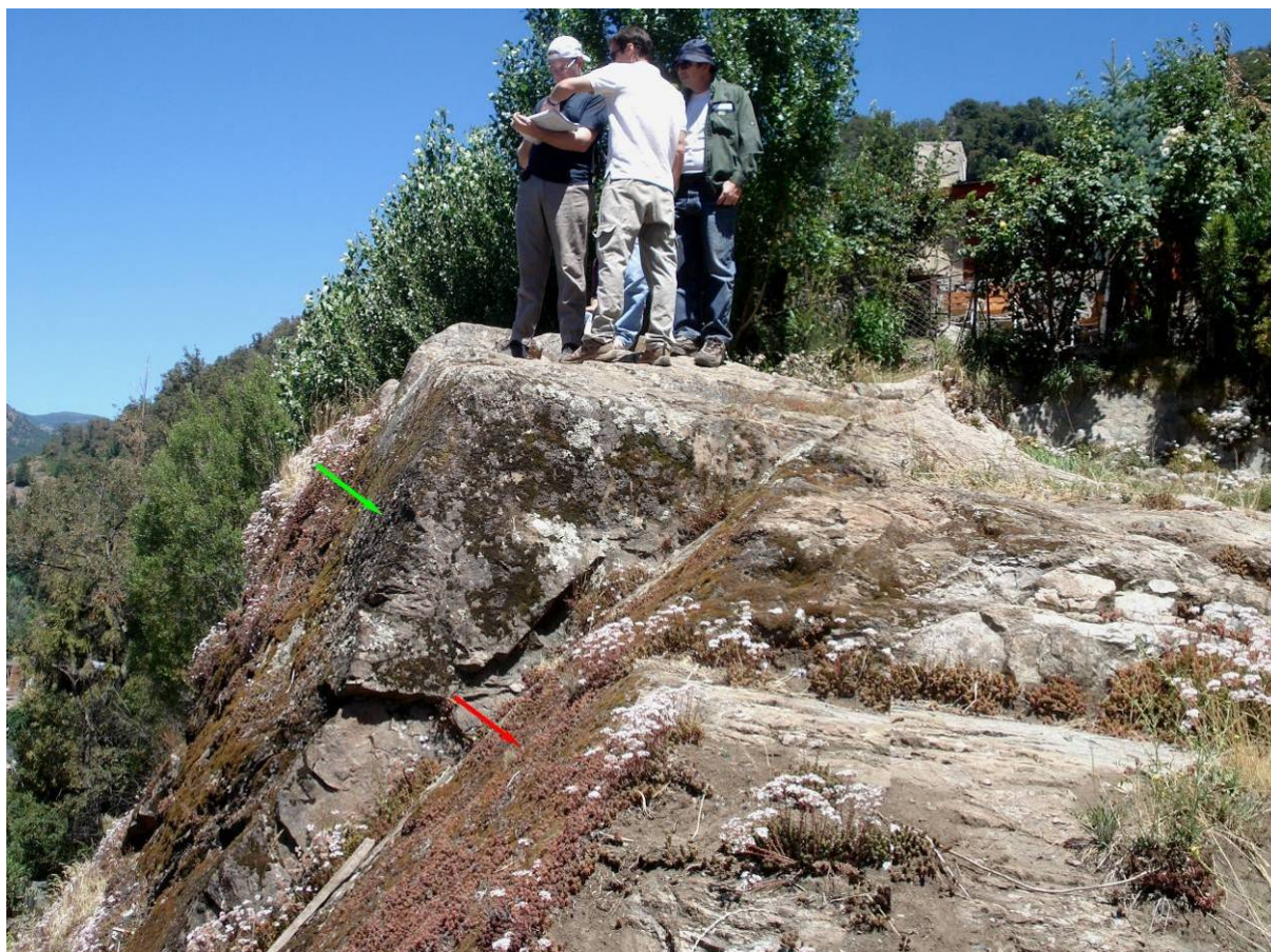
Figura 7-8 – Pendiente sobre las metamorfitas del Complejo Coiohuinca en la cual se observa el control estructural que imponen la presencia de fracturas que inclinan 40° (indicada con flecha roja) y 65° (indicada con flecha verde)
